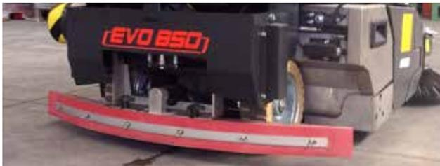
**EVO** non necessita di bandelle laterali o paraspruzzi perchè i flussi d'aria forzati mantengono la soluzione sempre entro la pista di lavaggio consentendo di utilizzare un tergi pavimento che non fuoriesce dall'ingombro della spazzola centrale fondamentale per spazzare-lavare contemporaneamente, ed una completa asciugatura anche effettuando raggi di sterzata molto stretti.
