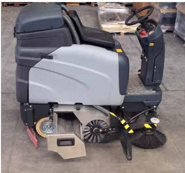
Sostituzione della spazzola centrale semplificata, svitando una sola vite si sfilava la leva di sostegno consentendo l'estrazione e una sostituzione rapidissima. Contenitore che consente la decantazione della soluzione lavante dei rifiuti raccolti contemporaneamente alla fase di lavaggio evitando così l'utilizzo di una precedente pulizia con la moto spazzatrice.
