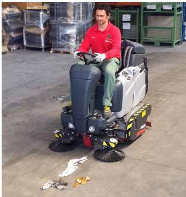
**EVO** è dotata di un sistema di dosaggio del detergente molto preciso, proporzionale all'erogazione dell'acqua e che non richiede lavaggi o spurghi del serbatoio-soluzione al momento del cambio di detergente.
