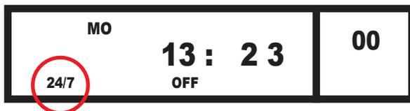
V pravém horním rohu se objeví blikající dvě nuly „00“. Stiskněte tlačítko „**PR**“ dokud se nezobrazí vedle dvou nul, blikající písmeno „**W**“, které označuje nastavení **vlastního programu difuze**.
