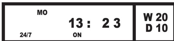
Pomocí tlačítka „**SET**“, potvrďte nastavení svého vlastního programu: vpravo nahoře bude uveden interval dávkování („**W working**“) a vpravo dole interval pauzy/stop („**D delay**“) mezi jednotlivými aktivními dávkami.
