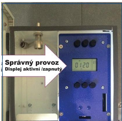
Na levé straně osvěžovače jdou vidět dvě kovové části. V prostřední části na hoře je fixní/pevná část, sloužící k našroubování náplně, druhá metalová část s hadičkou, slouží též k našroubování k náplni a zajišťuje přívod vzduchu.
