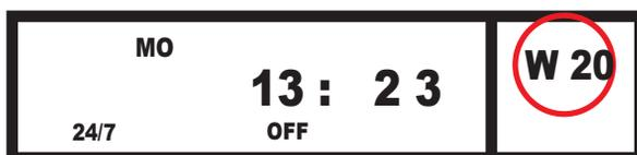
V pravém horním rohu program nadále bliká, zatímco v dolní rohu se programování změní z polohy „**OFF**“ (vypnuto / neaktivní) na „**ON**“ (připraveno k dávkování).
