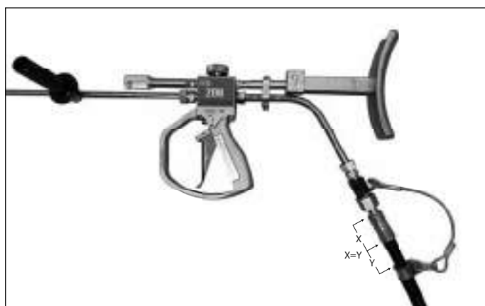
Správná montáž bezpečnostního lanka mezi hadicí a pistolí Dump.
